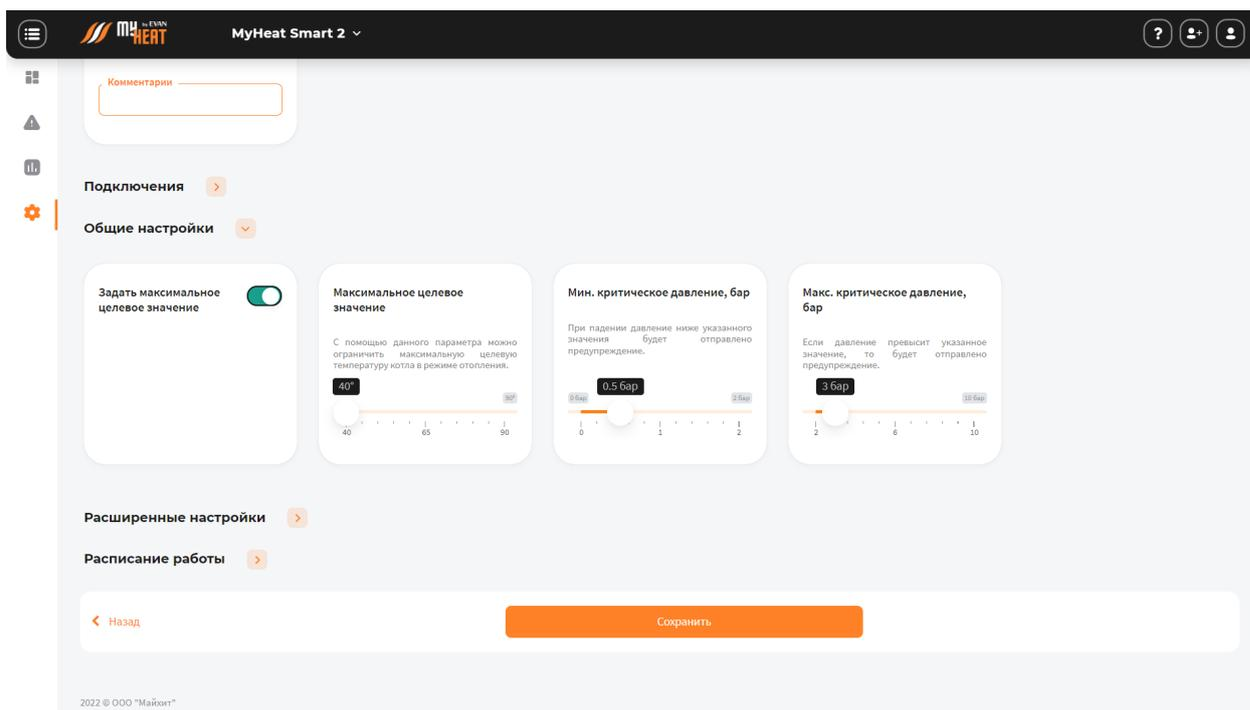
Установив флажок **Задать максимальное целевое значение** можно вручную ограничить максимальную целевую температуру котла в режиме отопления. В автоматическом режиме температура определяется системой по данным указанным в паспорте котла.
