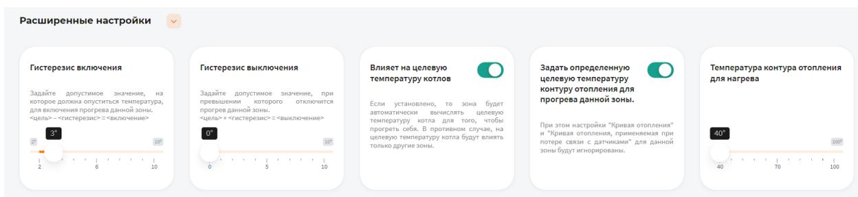
В поле **Гистерезис включения** выберите значение от 2° до 10°С. При понижении фактической температуры зоны относительно целевой температуры на размер заданного параметра включится нагрев (Например, установлена целевая температура 45°С с гистерезисом включения 3°С. Предположим, что температура ГВС 44°С. Когда температура достигнет 42°С включится нагрев ГВС).
