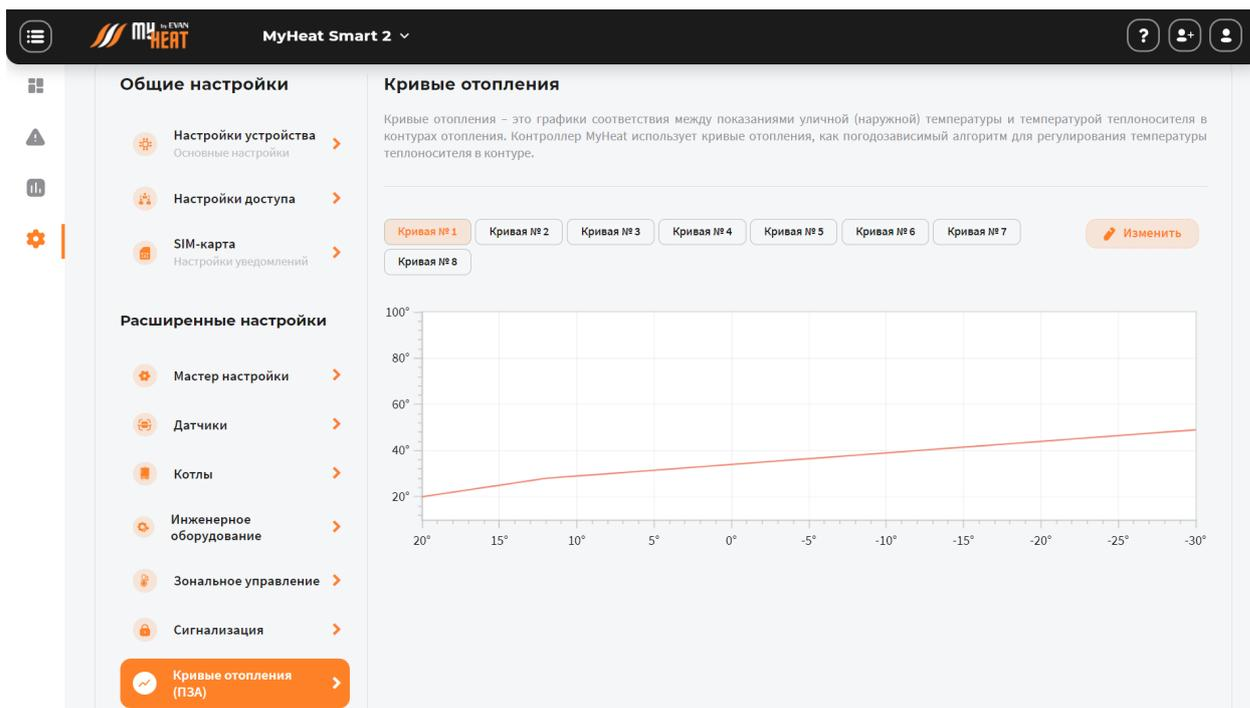
По умолчанию производитель включил в набор 8 предустановленных кривых отопления. Они охватывают практически весь диапазон возможных значений для бытового применения. По оси X графика обозначены уличные температуры, по оси Y соответствующие им температуры теплоносителя.
