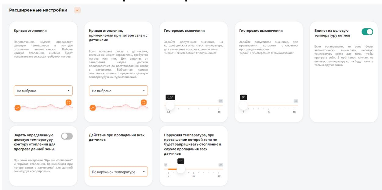
В поле **Кривая отопления** выберите кривую отопления, система будет использовать ее, когда требуется нагрев данной зоны. По-умолчанию MyHeat определяет целевую температуру в контуре отопления автоматически
