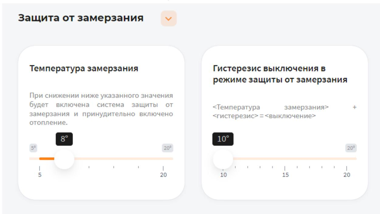
В поле **Температура замерзания** можно выбрать температуру от 5° до 20°C. При снижении указанного значения будет включена система защиты от замерзания и принудительно включено отопление.
