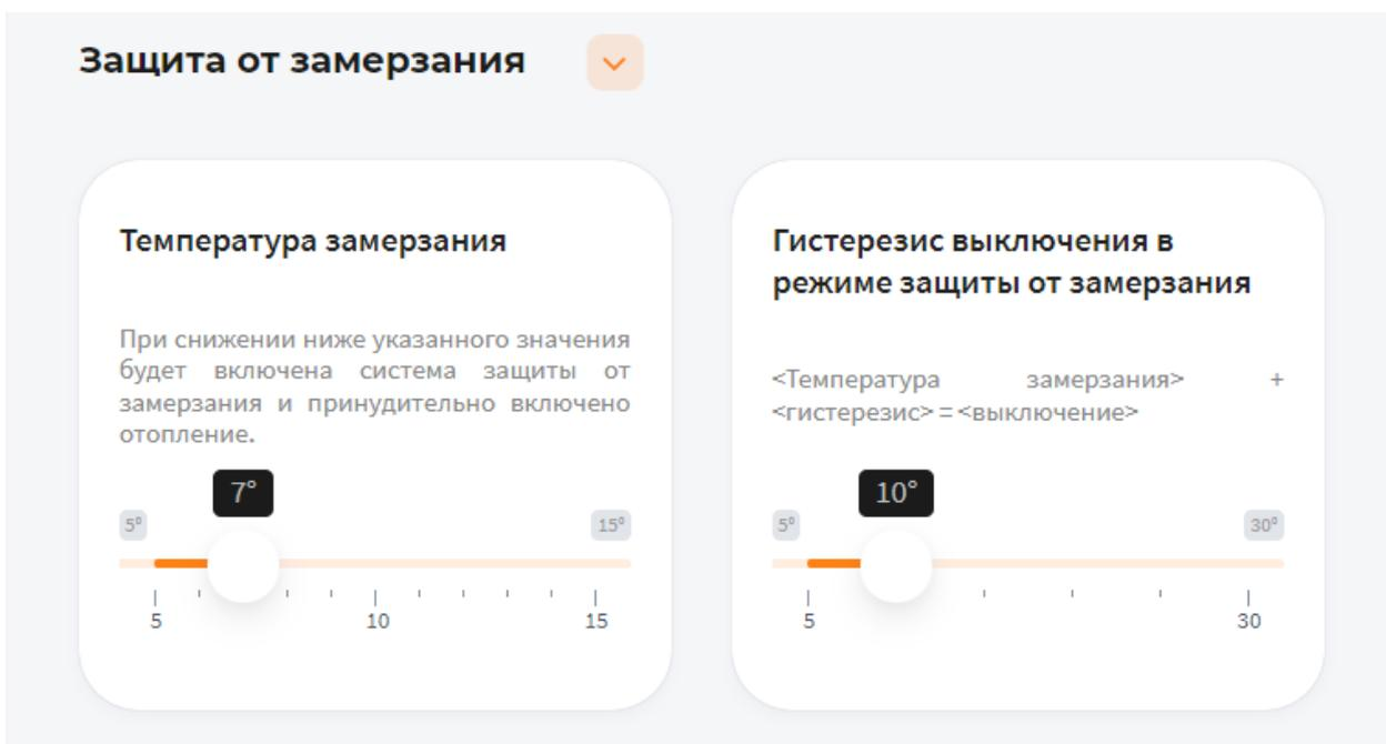
В поле **Температура замерзания** можно выбрать температуру от 5° до 15°C. При снижении указанного значения будет включена система защиты от замерзания и принудительно включено отопление.
