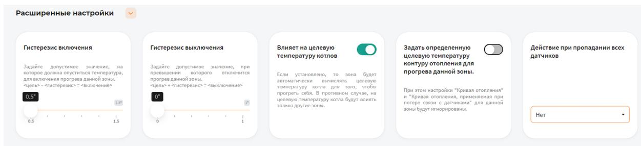
В поле **Гистерезис включения** выберите значение от 0.5° до 1.5°C. При понижении фактической температуры зоны относительно целевой температуры на размер заданного параметра включится нагрев (Например, установлена целевая температура 25°C с гистерезисом включения 0.5°C. Предположим, что температура бассейна 26°C. Когда температура достигнет 24.5°C включится нагрев бассейна).
