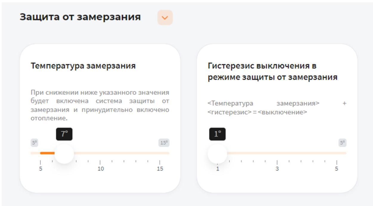
В поле **Температура замерзания** можно выбрать температуру от 5° до 15°С. При снижении указанного значения будет включена система защиты от замерзания и принудительно включено отопление
