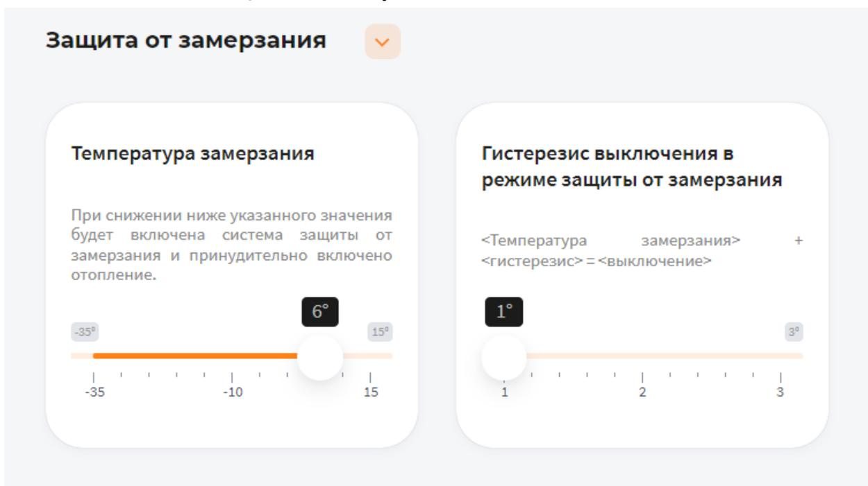
В поле **Температура замерзания** можно выбрать температуру от -35° до 15°C. При снижении указанного значения будет включена система защиты от замерзания и принудительно включено отопление
