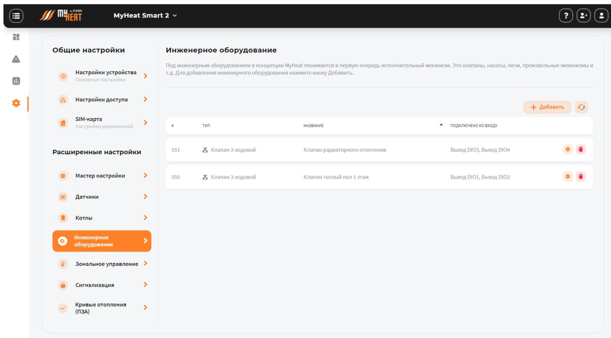
При добавлении Вы можете выбрать одно из восьми типов оборудования - клапан 2-ходовой, клапан 3-ходовой, клапан 4-ходовой, кран перекрытия воды, насос, печь, сирена или произвольный механизм .
