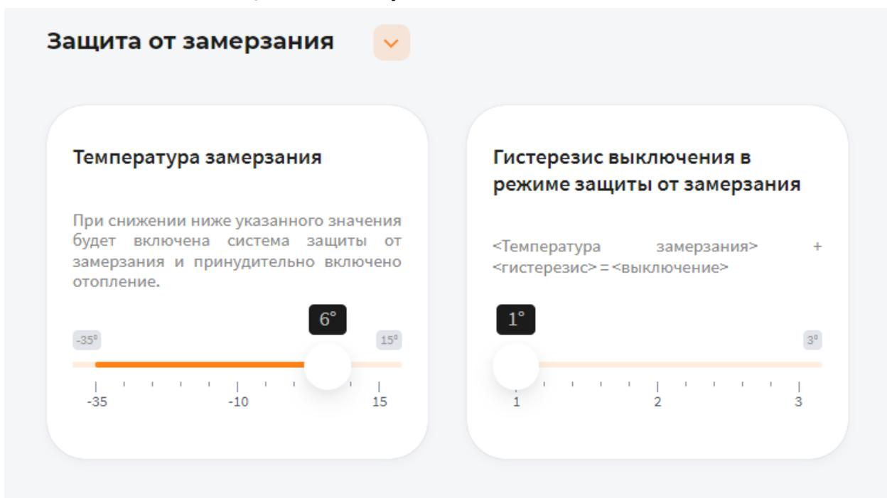
В поле **Температура замерзания** можно выбрать температуру от  $-35^{\circ}\text{C}$  до  $15^{\circ}\text{C}$ . При снижении указанного значения будет включена система защиты от замерзания и принудительно включено отопление
