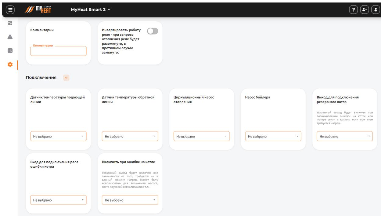
При создании котла без цифровой шины данных управление производится через релейный выход (указывается в выпадающем списке **Подключено к**). При этом контроллеру необходимо получать информацию о температуре в контуре отопления на подающей и обратной линии. Для этого во вкладке **Подключения** выберите из списка датчики температуры подающей и обратной линии.
