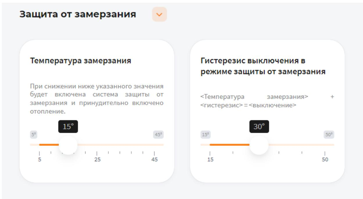
**Температура замерзания** – температура зоны, при которой будет включено принудительное отопление. Настройка является дополнительной подстраховкой для случаев, когда целевая температура не задана или зоне недостаточно тепла ввиду неправильной настройки или проектирования системы теплоснабжения.
