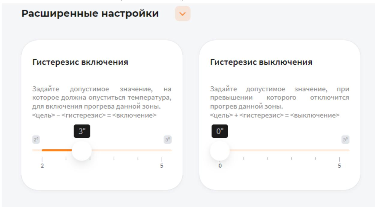
В поле **Гистерезис включения** выберите значение от 2° до 5°C. При понижении фактической температуры зоны относительно целевой температуры на размер заданного параметра включится нагрев (Например, установлена целевая температура 25°C с гистерезисом включения 3°C. Предположим, что температура помещения 70°C. Когда температура достигнет 67°C включится нагрев помещения)
