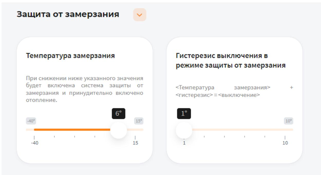
В поле **Температура замерзания** можно выбрать температуру от -40° до 15°C. При снижении указанного значения будет включена система защиты от замерзания и принудительно включено отопление
