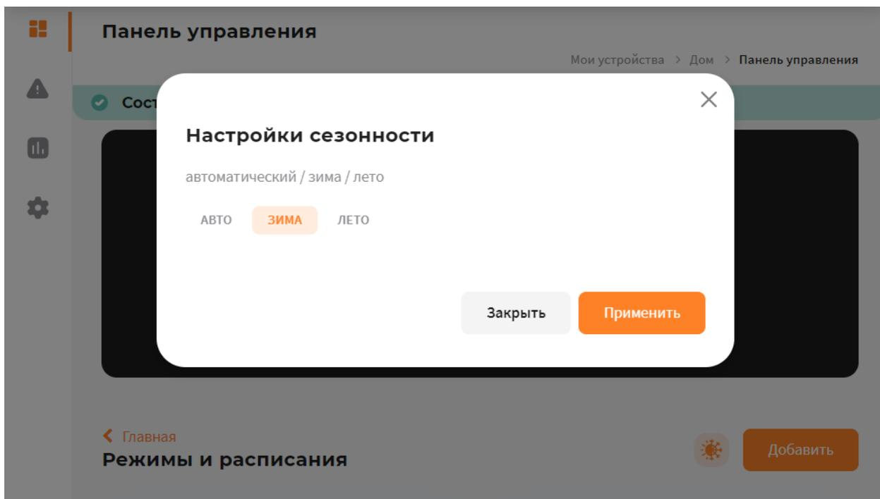
Нажмите на нее для переключения между режимами вручную. В автоматическом режиме контроллер самостоятельно будет переключать на режим ЛЕТО, если уличная температура больше +24°C и на режим ЗИМА, если уличная температура ниже +17°C.
