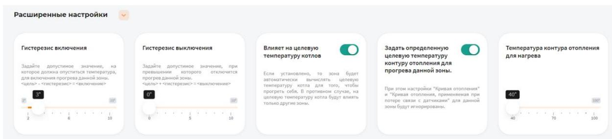
В поле **Гистерезис включения** выберите значение от 2° до 10°C. При понижении фактической температуры зоны относительно целевой температуры на размер заданного параметра включится нагрев (Например, установлена целевая температура 45°C с гистерезисом включения 3°C. Предположим, что температура ГВС 44°C. Когда температура достигнет 42°C включится нагрев ГВС).
