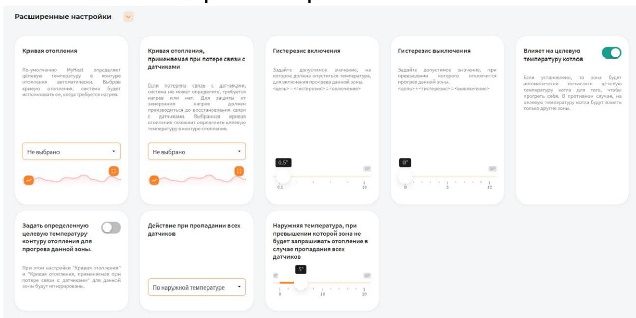
В поле **Кривая отопления** выберите кривую отопления, система будет использовать ее, когда требуется нагрев данной зоны. По-умолчанию MyHeat определяет целевую температуру в контуре отопления автоматически. Выбрав кривую отопления, система будет использовать ее, когда требуется нагрев.
